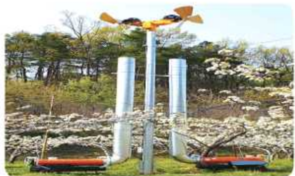
〈열풍 방상팬 설치 모습〉
