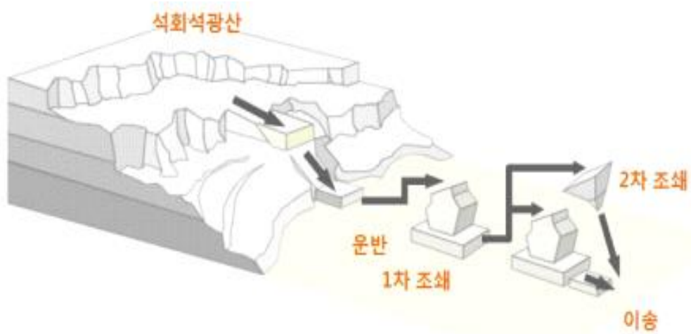
자료출처 : 한국시멘트협회, 시멘트산업 공정특성과 순환자원 재활용, 2014 [그림Ⅲ.2- 4] 시멘트 제조공정(채광)
